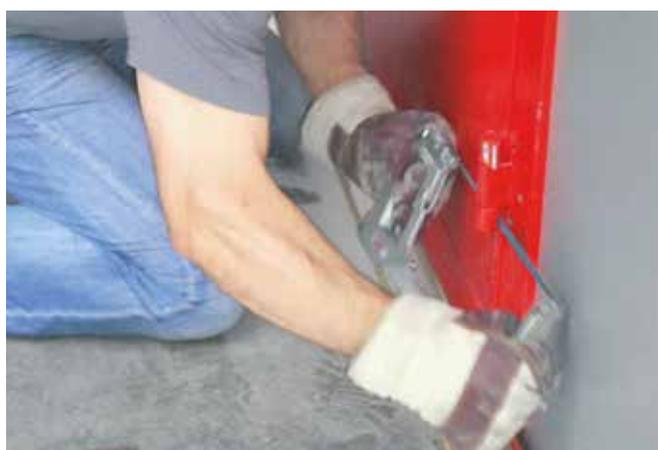
Essai d'effraction : tentative d'effraction au niveau des charnières
